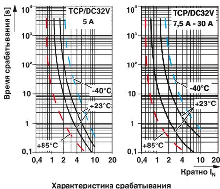
**Автоматический выключатель с тепловым расцепителем TCP**
