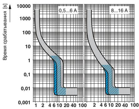
Характеристика срабатывания серый: диапазон постоянного тона, синий: диапазон переменного тона
