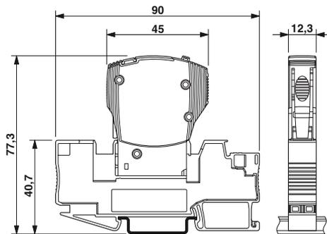
На рисунке показан модуль в сборе, состоящий из базового элемента и штенерного модуля
